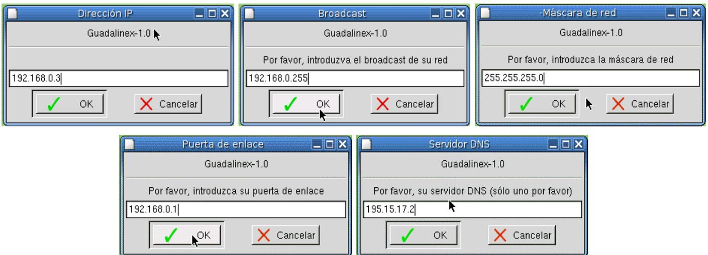
Estos parámetros son: La dirección IP del equipo, la dirección de Broadcast, la Máscara de Red, la Puerta de Enlace y el Servidor de DNS predeterminado.
