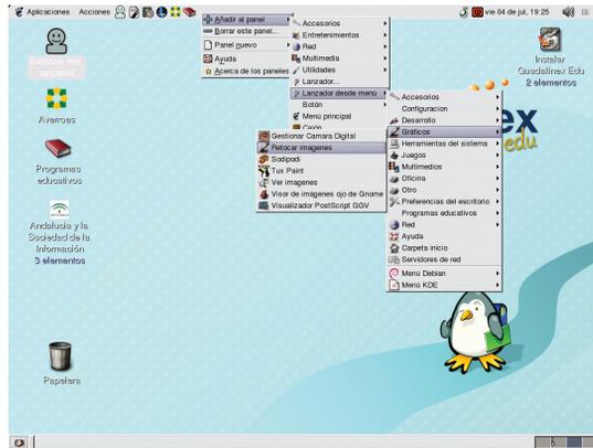
Si posteriormente deseamos eliminar este lanzador del panel, bastará con situarse sobre él y, pulsando con el botón derecho del ratón, elegir «Quitar del panel» en el menú emergente que nos ofrece.
